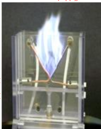
Rys. 4. Laboratoryjna instalacja plazmowa (Niemira, 2014)
