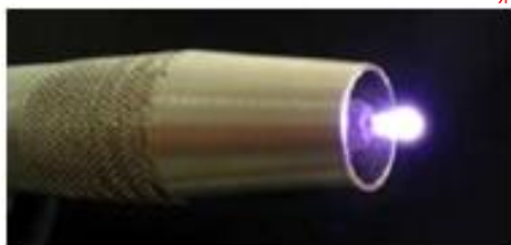
Rys. 3. Mikropalnik plazmowy (Zieliński, 2007)
